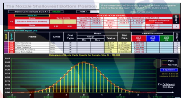
รูปที่ 4 การคำนวณความลึกของเข็มขณะทำการฉีดการเทียบกับผิวด้านล่างของ HSA ตามแนวทาง Monte Carlo Simulation
