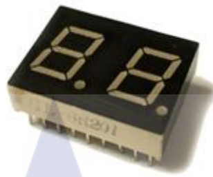
รูปที่ 2.11 LED ชนิด 7 Segments สำหรับ Display หรือแสดงผลเป็นตัวเลข
