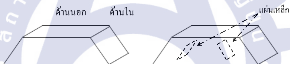
รูปที่ 2.53 แสดงลักษณะฝาครอบหลังการปรับปรุง
