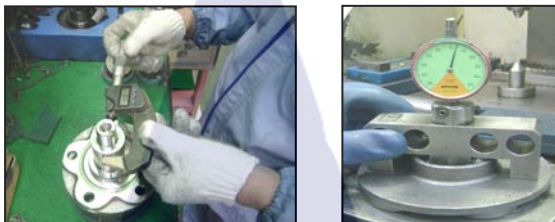
รูปที่ 2.6 แสดงการใช้ Micrometer และ Dial gauge
