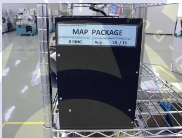
รูปที่ 3.28 แมกกาซีนบรรจุงานที่ติดบัตร Kanban พร้อมใช้แล้ว
