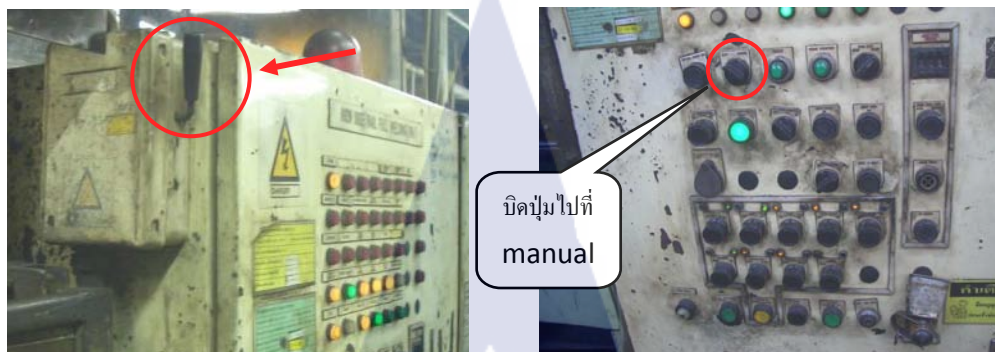
รูปที่ 2.9 แสดงปุ่มบนแผงวงจรควบคุม Robot
