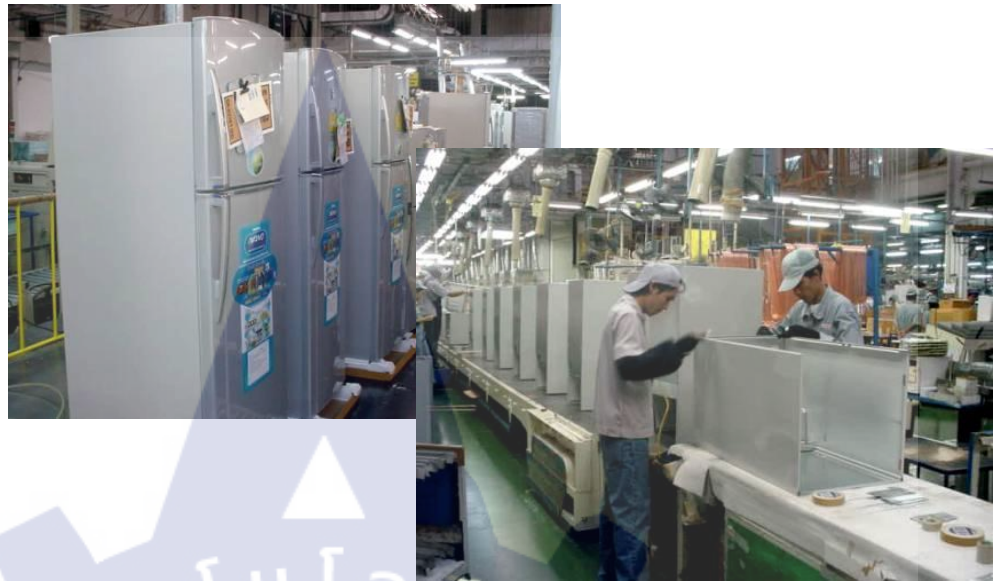
ภาพที่ 1.3 สายการผลิตตู้เย็นเทคนิคการผลิตแบบ Conveyor Line Assembly
