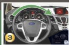
3 พวงมาลัยได้รับการชดเชยน้ำหนักด้วย EPAS ที่รอบเครื่องยนต์
