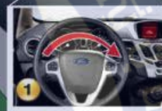
1 ลูกกรงสีแดง = ผู้ขับขี่ต้องออกแรงบังคับพวงมาลัย
