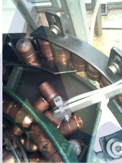
รูป 3.25 แสดงการเคลื่อนที่ไปตามรางของTIP
