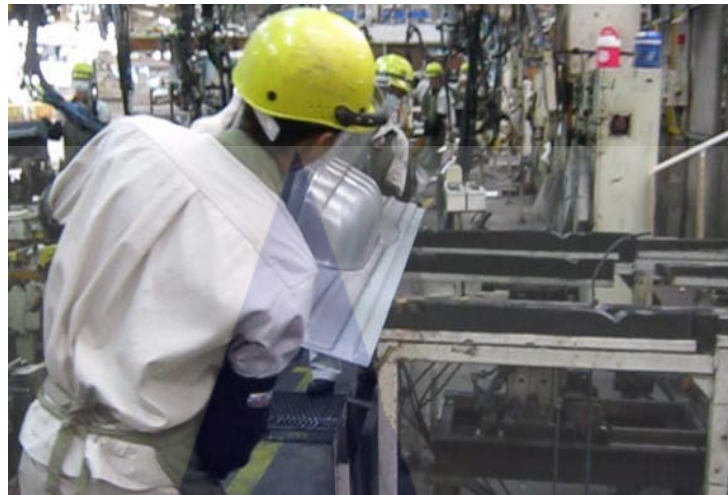
รูปที่ 4.3 แสดงการยก Part วางลงบน Buffer
