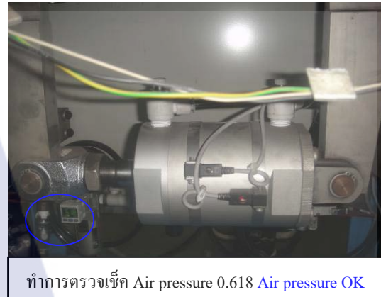
รูปที่ 3.27 ตรวจสอบ Air pressure เปรียบเทียบกับ Spec
