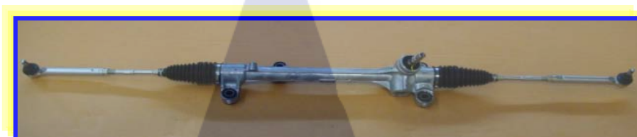
รูปที่ 1.3 แสดง Rack & Pinion ชนิด Electric Power Steering
