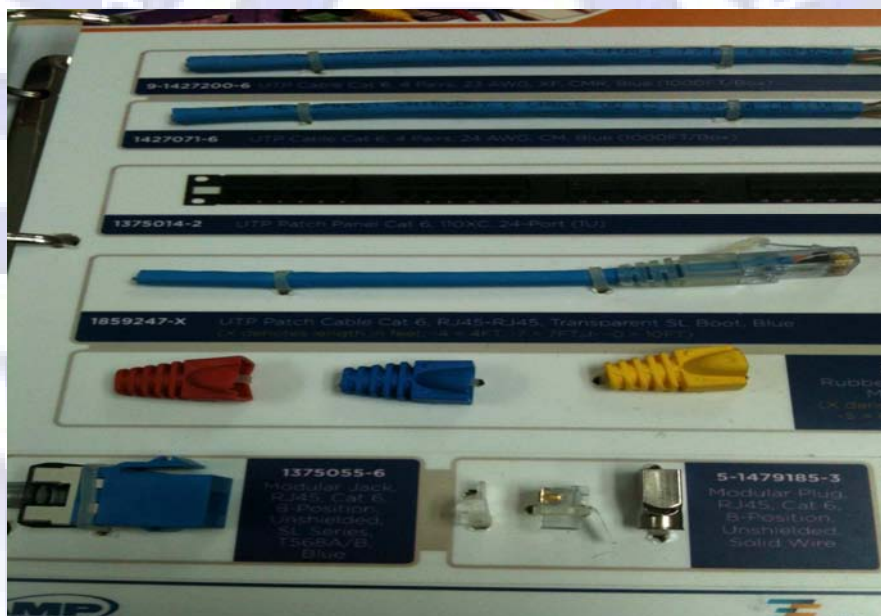
รูปที่ 3.1 ชนิดของสาย UTP หัวตัวผู้ และ หัวตัวเมีย ที่ใช้ในการปฏิบัติงาน
