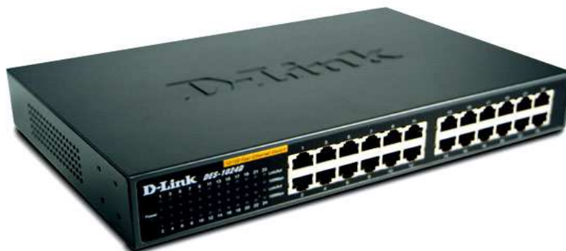
รูปที่ 2.5 Switch
