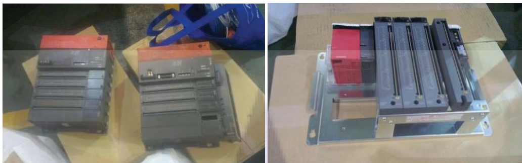
รูปที่ 4.1 ภาพแสดงการเปลี่ยน PLC รุ่น A-Series และ PLC รุ่น Q-Series
