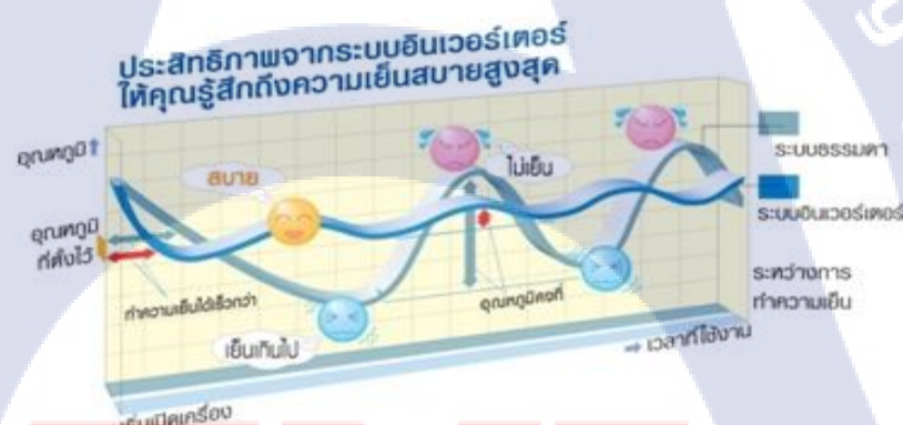
ภาพที่ 1.8 การเปรียบเทียบความเย็นระหว่างระบบธรรมดากับระบบอินเวอร์เตอร์
