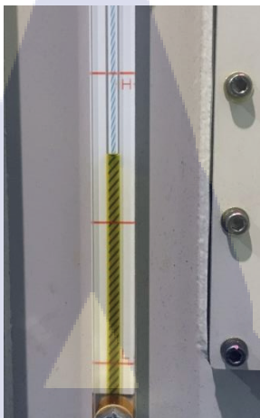
รูปที่ ก.6 ระดับน้ำมันที่อยู่ในช่วง H ขณะปิดเครื่อง
