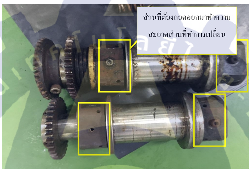
รูปที่ 3.15 ส่วนประกอบตัวคลุ่มฮีเตอร์ที่ไม่ได้ทำการเปลี่ยนอะไหล่แต่ต้องถอดออกมาทำความสะอาด
