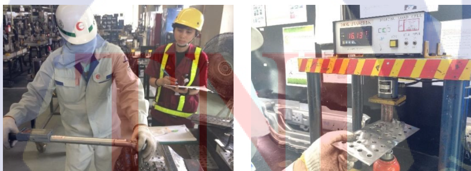
รูปที่ 20 บันทึกค่าการทดสอบความแข็งแรงทั้งแรงบิดและแรงกดบริษัทผู้ผลิต 4
