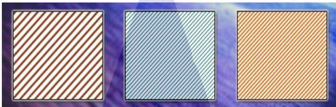
รูปที่ 2.12 แสดงลักษณะคมตัดเดี่ยว
