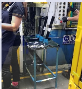
ภาพที่ 3.4 ภาพขณะพนักงานใช้ Support table สำหรับ Shock absorber Rear
