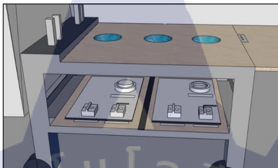
ภาพที่ 3.12 แบบของชั้นวาง Tooling ออกแบบโดยใช้โปรแกรม Sketch up
