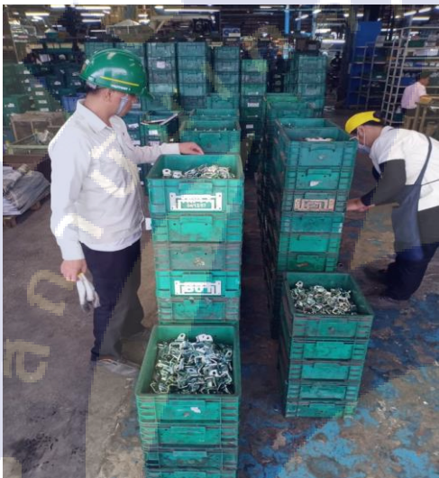
รูปที่ 3.9 Stock ชุบแข็งแล้วQCตรวจสอบ
