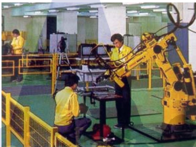
ภาพที่ 2.18 การสอนหุ่นยนต์อุตสาหกรรมให้ทำงานเชื่อมโดยสั่งงานผ่าน เป็นสอน(ผู้ที่นั่งเป็นคนถือแป้น) [20]
