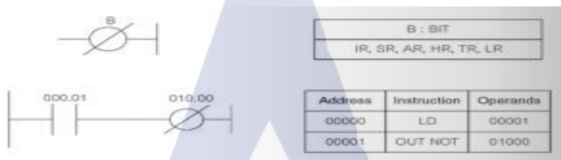
รูปที่ 2.12 OUTPUT NOT-OUT NOT การทำงานของคำสั่งเหล่านี้จะตรงข้ามกับ OUT
