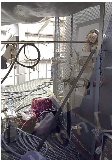
ภาพที่ 3. 13 แสดงตำแหน่งของจุดเก็บ ตัวอย่างตามขนาดของปล่องจุดที่ 1
