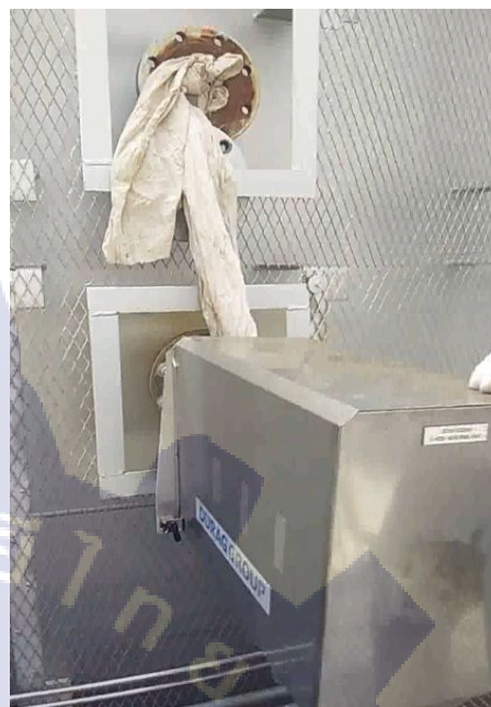
ภาพที่ 3. 12 แสดงตำแหน่งของจุดเก็บ ตัวอย่างตามขนาดของปล่องจุดที่ 2
