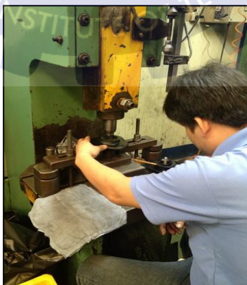
รูปที่ 3.13 แสดงขั้นตอนการอัดลูกปืน
