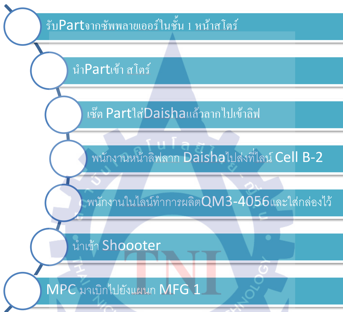
ภาพที่3.9แผนภาพกระบวนการ โลจิสติกส์Hand Soldering
