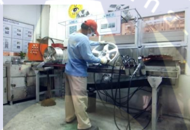
รูปที่ 4.4 กระบวนการ Inspection Casting
