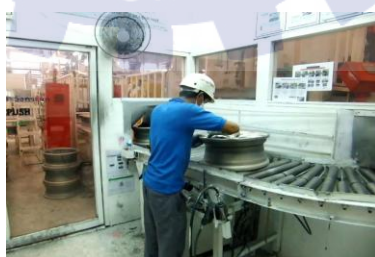
รูปที่ 4.11 กระบวนการ Inspection Before CNC
