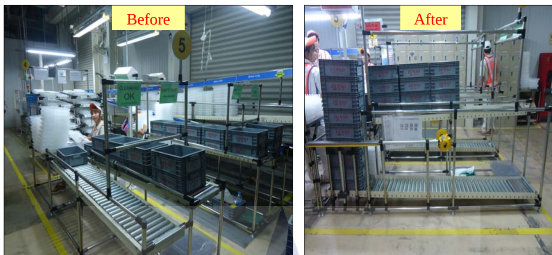
รูปที่ 4.9 รูป Chutter ที่ติดกับ โต๊ะ Inspection
