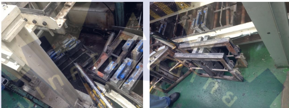
ภาพที่ 4.7 ปัญหาสภาพรางเก่าทำให้ PALLET เปล่าตกราง
