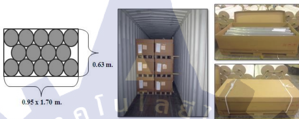
ภาพที่ 3.14 การจัดเรียงผ้าใส่ Biwall หลังปรับปรุง
