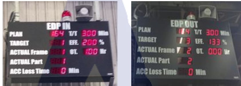
รูปที่ 4.12 จอ Andon Board ของไลน์ซูป EDP หลังการปรับปรุง ที่มา : บริษัท อีโน มอเตอร์ส แมนูแฟคเจอร์ริง (ประเทศไทย) จำกัด
