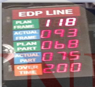
รูปที่ 4.11 จอ Andon Board ของไลน์ชุด EDP ก่อนการปรับปรุง ที่มา : บริษัท ฮีโน่ มอเตอร์ส แมนูแฟคเจอร์ริง (ประเทศไทย) จำกัด
