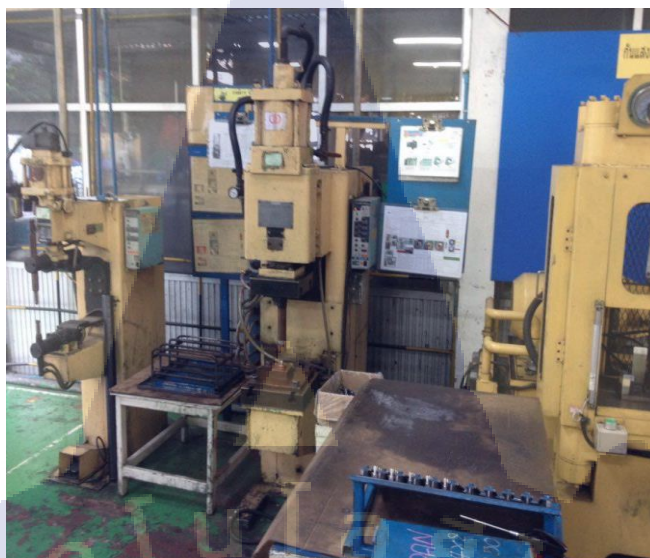
ภาพที่ 3.9 แสดงถึงเครื่อง Stamp Spot Welding
