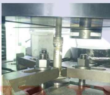
ภาพที่ 4.5 INNER PIPE ขณะทดสอบค่า Welding Strength
