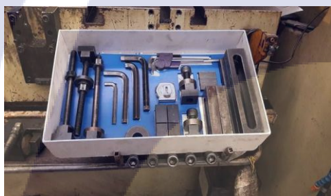
ภาพที่ 4.9 การเก็บอุปกรณ์ที่ใช้ในการติดตั้งแม่พิมพ์ (Set Up) หลังการปรับปรุง
