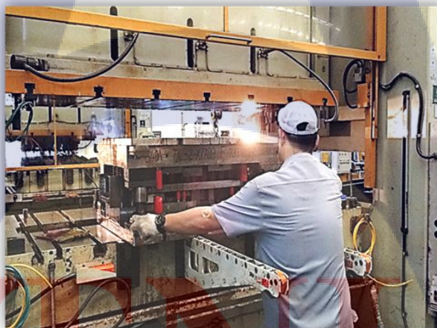
ภาพที่ 4.3 ขั้นตอนการติดตั้งแม่พิมพ์ (Set Up)
