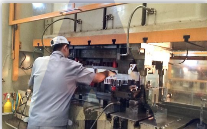
ภาพที่ 4.4 ขั้นตอนการติดตั้งแม่พิมพ์ (Set Up)
