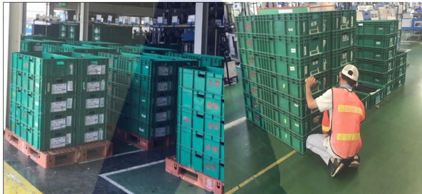
ภาพที่ 4.5 TPman นำ Parts ออกไปวางที่ Staging Area และทำการ Scan barcode เพื่อตรวจสอบความถูกต้อง
