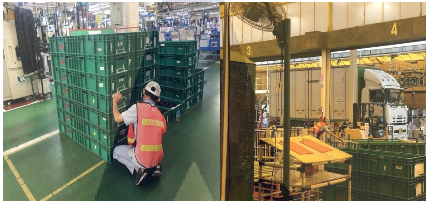
ภาพที่ 3.6 ขั้นตอนที่ 5 TPman Scan Barcode ตรวจสอบ Parts และ โหลดของขึ้นรถ ตามรอบเวลาและจัดส่งไปยังลูกค้า
