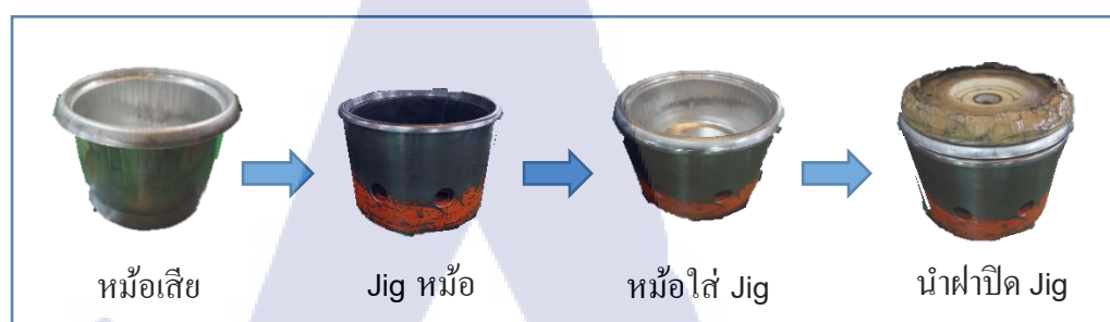
ภาพที่ 5.2 การสำรองหม้อเสีย เพื่อใช้ตั้งใบมีดของเครื่องรีดขอบ
