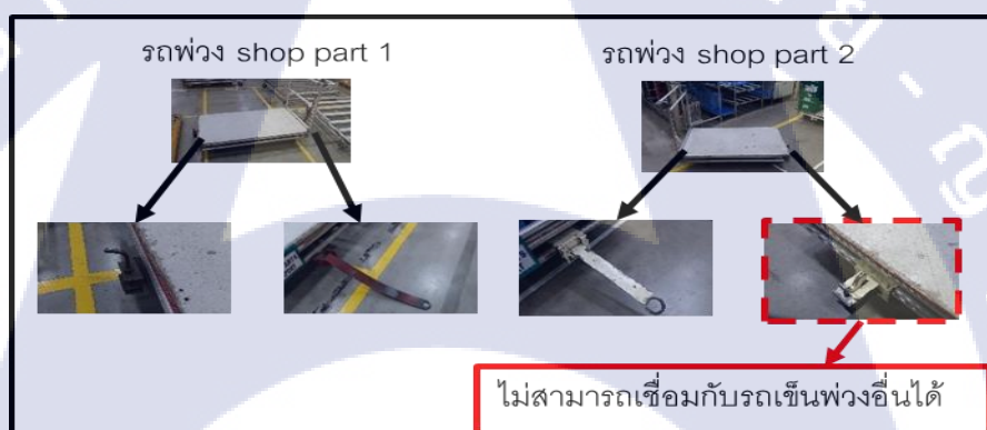
ภาพที่ 4.4 ภาพหัวต่อรถเข็นพ่วงทั้ง 2 รูปแบบก่อนการปรับปรุง
