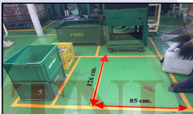
ภาพที่ 5.5 จำนวนลังชิ้นงาน Plug Angle และพื้นที่ในการจัดเก็บ หลังปรับปรุง
