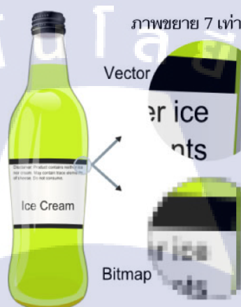
ภาพที่ 2.19 ความแตกต่างระหว่างรูปแบบ vector และแบบ pixel
