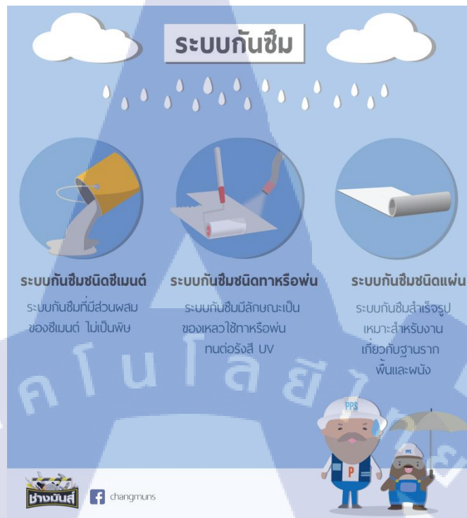
ภาพที่ 3.5 Infographic เรื่องประเภทของระบบกันซึม
