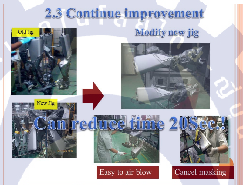
รูปที่ 4.19 รูป jig ใหม่ที่ทำการปรับปรุง(2)
