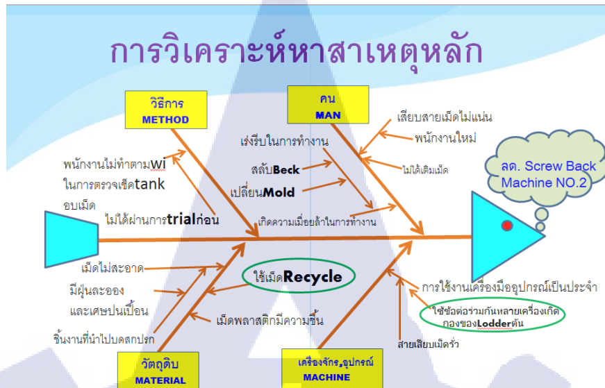
รูปภาพที่ 4.1 Cause and Effect diagram's Screw back problems
