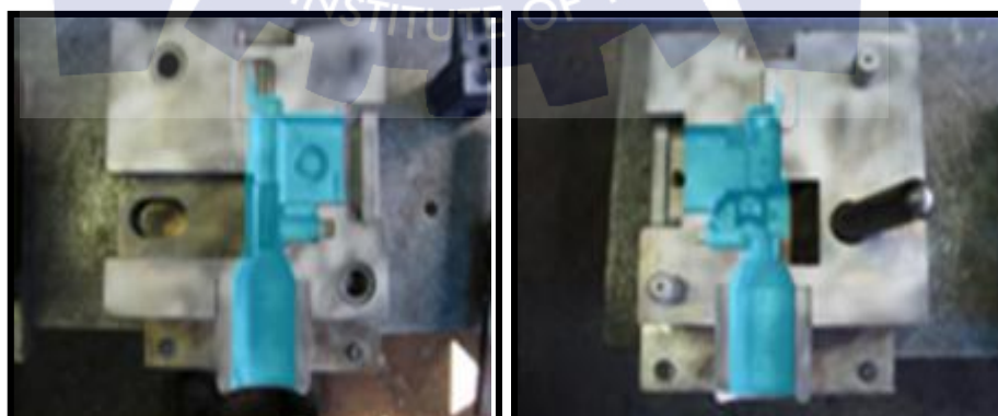
ภาพที่ 2.15 พ่นน้ำยาเคลือบแม่พิมพ์
