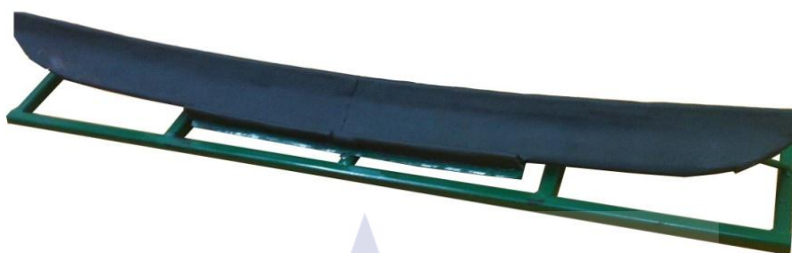
ภาพที่ 3.11 ภาพแสดง Jig ASM Garnish Tail gate RF10 ก่อนปรับปรุง
