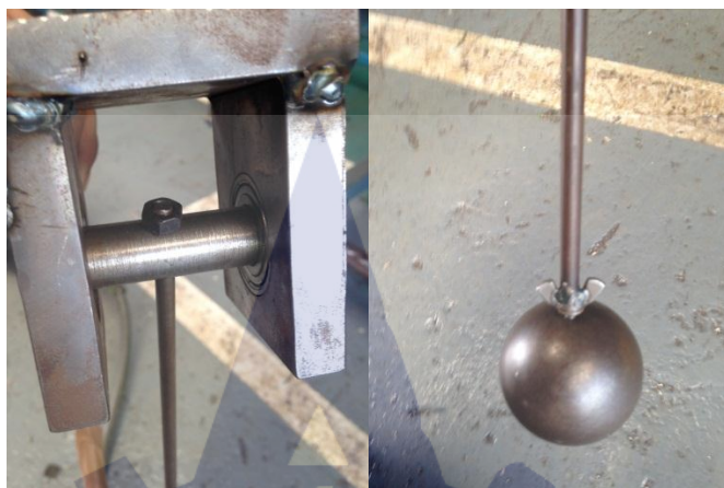
ภาพที่ 3.17 ภาพแสดงลักษณะการประกอบระหว่าง ลูกตุ้ม-เหล็กเส้น , เหล็กเส้น-กลไกแกว่ง
