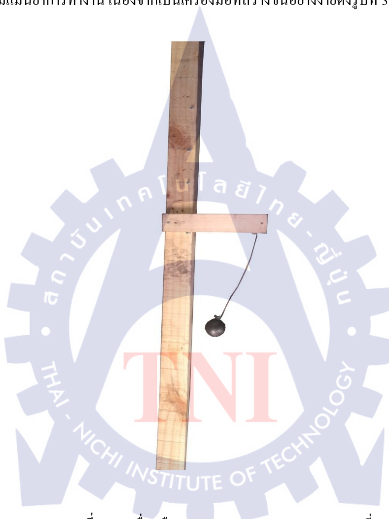
ภาพที่ 3.9 เครื่องมือทดสอบ Impact resistance แบบเหวี่ยง
