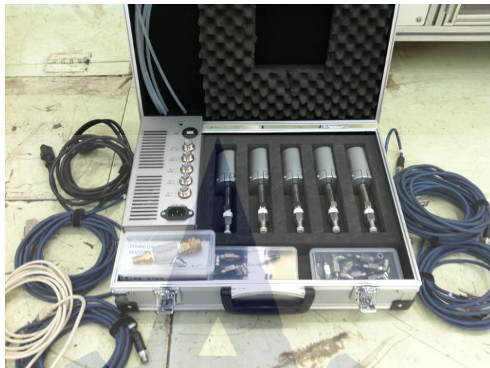
รูปที่ 3.4 Pirani Gauge Sensor ที่ใช้ในการปฏิบัติงาน
