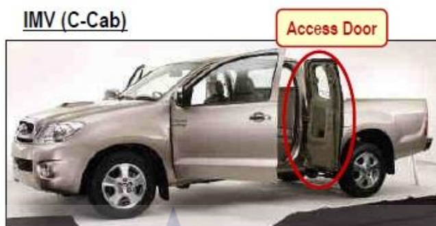
รูปที่ 1.3 การปรับปรุง VIGO รุ่น C-Cab ให้มี Access Door
