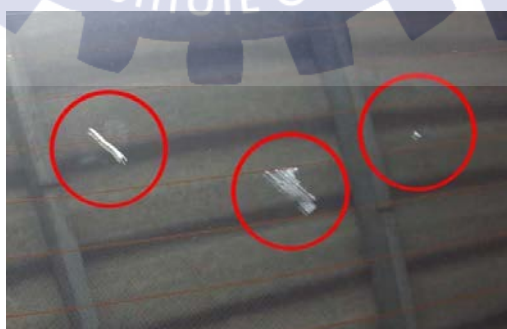
รูปที่ 4.10 แสดงรูปกระจกเป็นรอยลึกมากๆ
