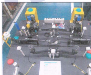
รูปที่ 3.6 แสดงตัวอย่าง Jig Assy ของกระบอกหน้า
