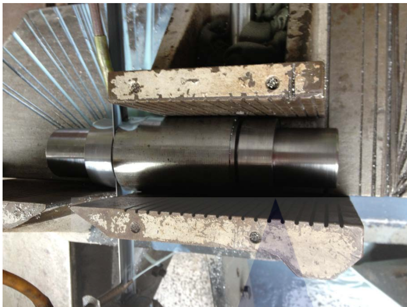
รูปที่ 3.29 การตัดชิ้นงานให้ได้ตามขนาด drawing ด้วยเครื่อง Band saw
