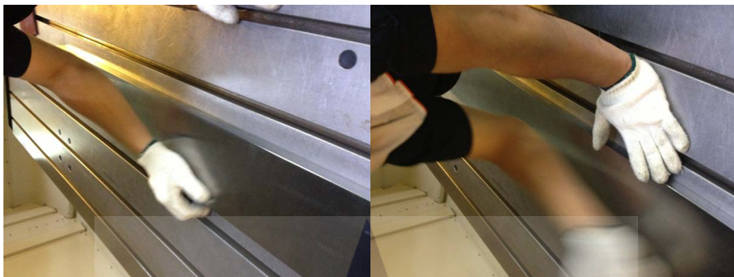
รูปที่ 3.7 เช็คความโค้งของชิ้นงาน
