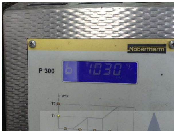
รูปที่ 3.47 ตั้งอุณหภูมิที่ 1030 c
