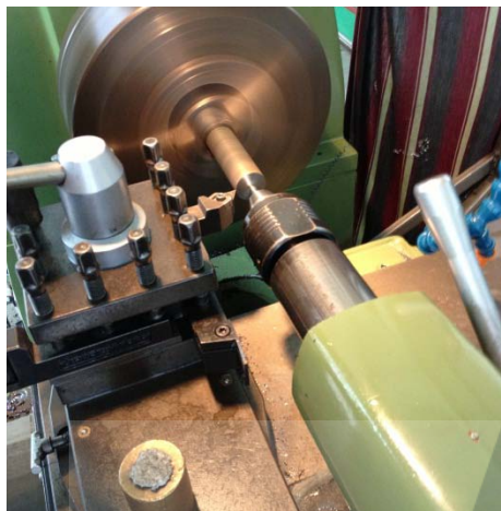
รูปที่ 3.43 การกลึงชิ้นงานด้วยเครื่องกลึง
