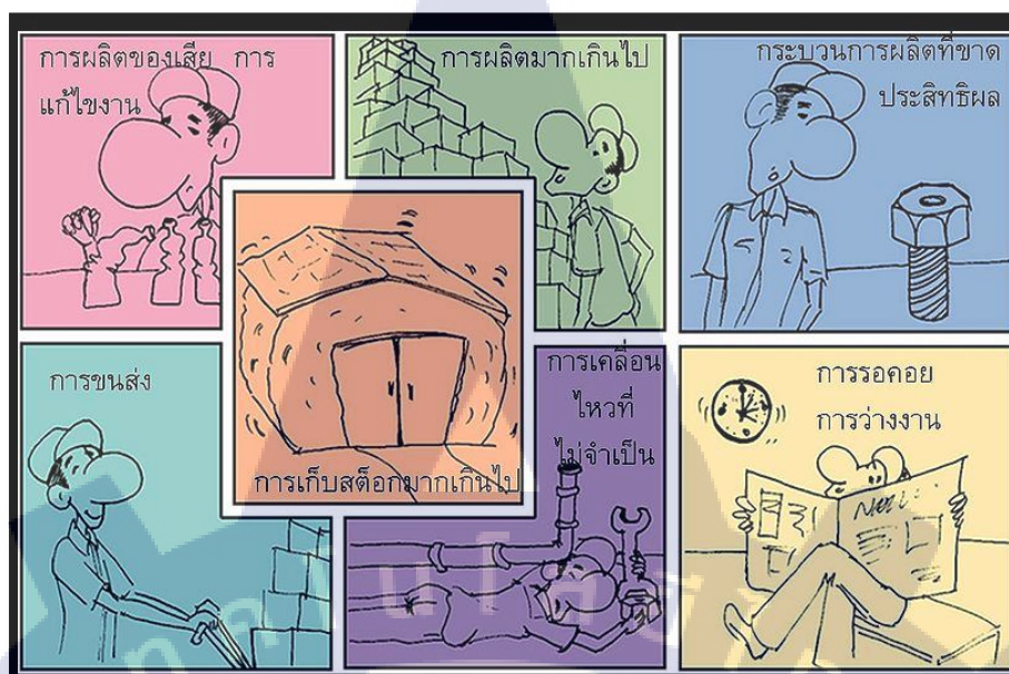
ภาพที่ 2.2 แสดงภาพความสูญเสีย (Muda) ทั้ง 7 ประการ นอกจากนี้ยังมี MURI คือ การรับภาระเกินความสามารถของบุคคลและอุปกรณ์ MURA คือ แผนการผลิตหรือปริมาณการผลิตที่ไม่สม่ำเสมอ
