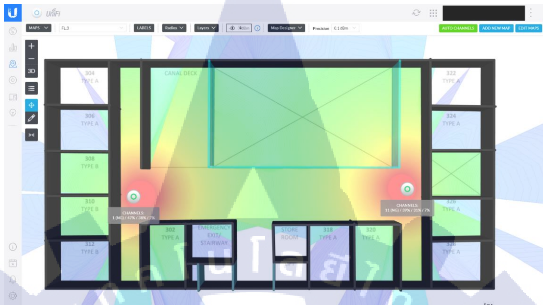
รูปที่ 3.3 Old Network Wi-Fi Heat Map RSSI -80 dBm
