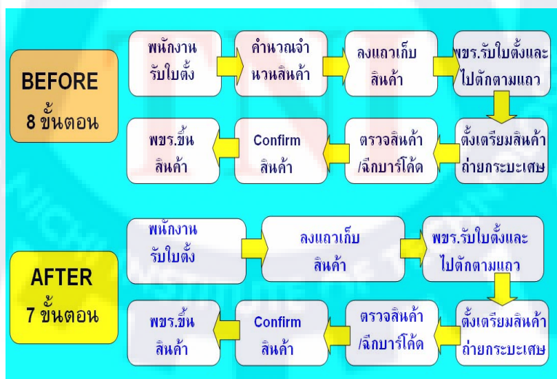
รูปที่ 44 เปรียบเทียบขั้นตอนการทำงานก่อนการแก้ไข - หลังการแก้ไข
